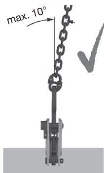
Abb. 12: Maximal zulässige Schräglast: 10^\circ
