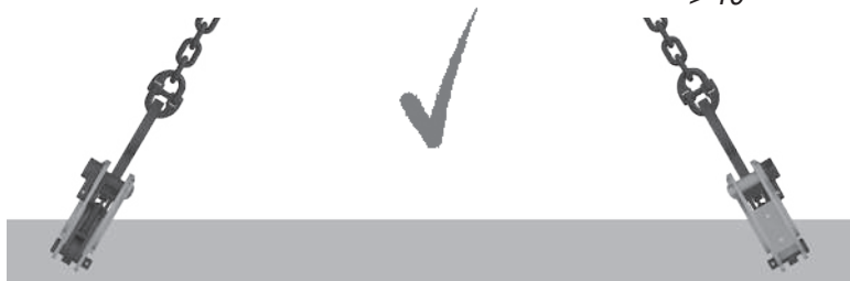
Fig. 6: Carico consentito: morsa in linea con la corda
