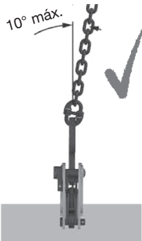
Fig. 12: Máxima carga transversal permitida: 10°
