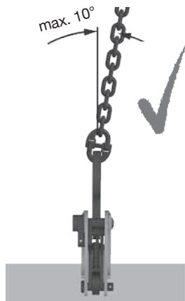
Fig. 4: Carga transversal máxima: 10^\circ
