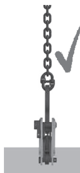
Abb. 11: Optimale horizontale Last
