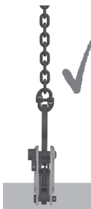
Fig. 3: Charge horizontale optimale
