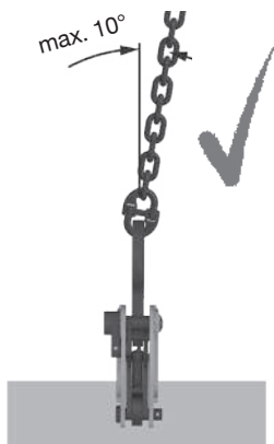
Fig. 12: Charge transversale maximale autorisée: 10°
