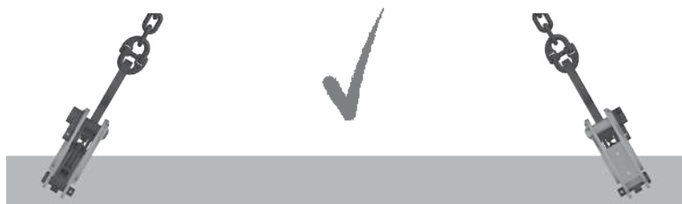
Abb. 14: Zulässige Last: Hebeklemme auf einer Linie mit der Schlinge
