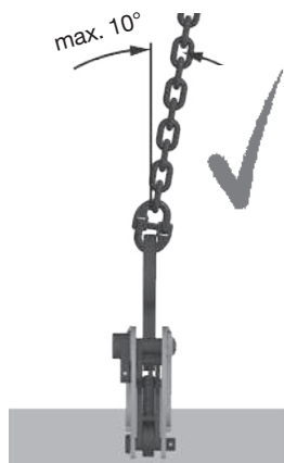
Fig. 4: Charge transversale maximale autorisée: 10°
