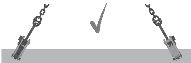
Fig. 6: Carga permitida: La garra alineada con el cable
