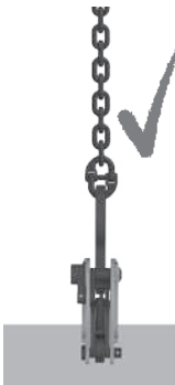
Fig. 11: Carga horizontal óptima
