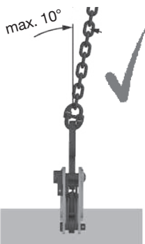
Fig. 12: Carico trasversale massimo consentito: 10°
