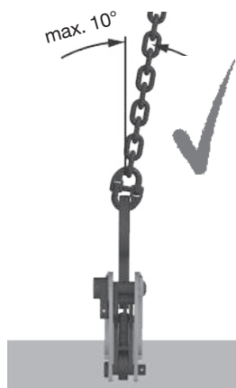
Fig. 4: Carico trasversale massimo consentito: 10^\circ
