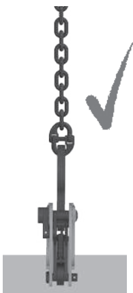
Abb. 3: Optimale horizontale Last
