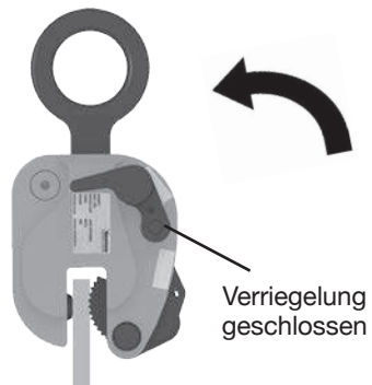
Abb. 20: Hebeklemme/ Verriegelung schließen
