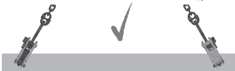
Fig. 14: Carico consentito: morsa in linea con la corda
