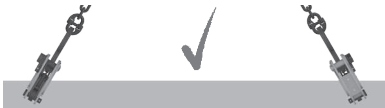
Fig. 14: Charge autorisée : Pince en ligne avec l'élingue
