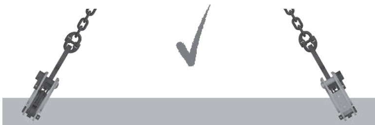
Abb. 6: Zulässige Last: Hebeklemme auf einer Linie mit der Schling
