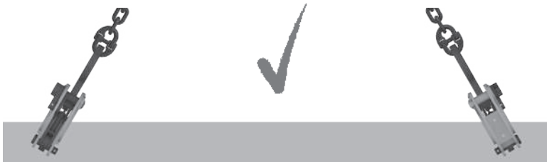
Fig. 14: Carga permitida: La garrá alineada con el cable
