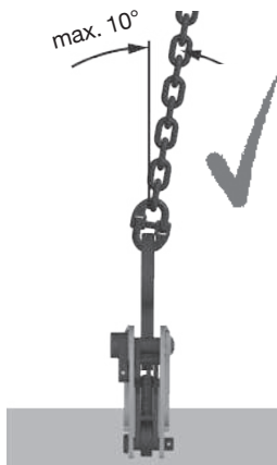
Abb. 4: Maximal zulässige Schräglast: 10^\circ
