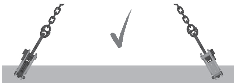
Fig. 6: Charge autorisée : Pince en ligne avec l'élingue
