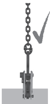
Fig. 11: Carico orizzontale ottimale
