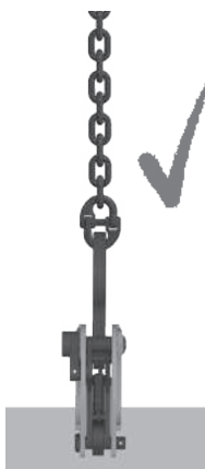
Fig. 3: Carga horizontal óptima
