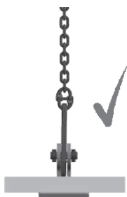
Abbildung G - Schlinge lotrecht oberhalb und in einer Linie mit der Greifbacke.
