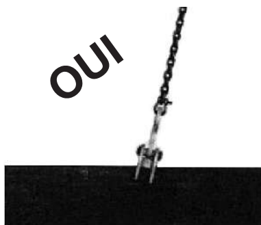
Photographie E (Typique) L'élingue est placée directement en ligne avec la manille de levage.
