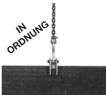
Foto B (charakteristisch) Schlinge lotrecht oberhalb und in einer Linie mit der Aufhängeöse
