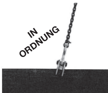
Foto E (charakteristisch) Schlinge in einer Linie mit der Aufhängeöse
