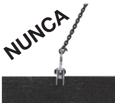
Fotografía D (Característico) Carga lateral excesiva.
